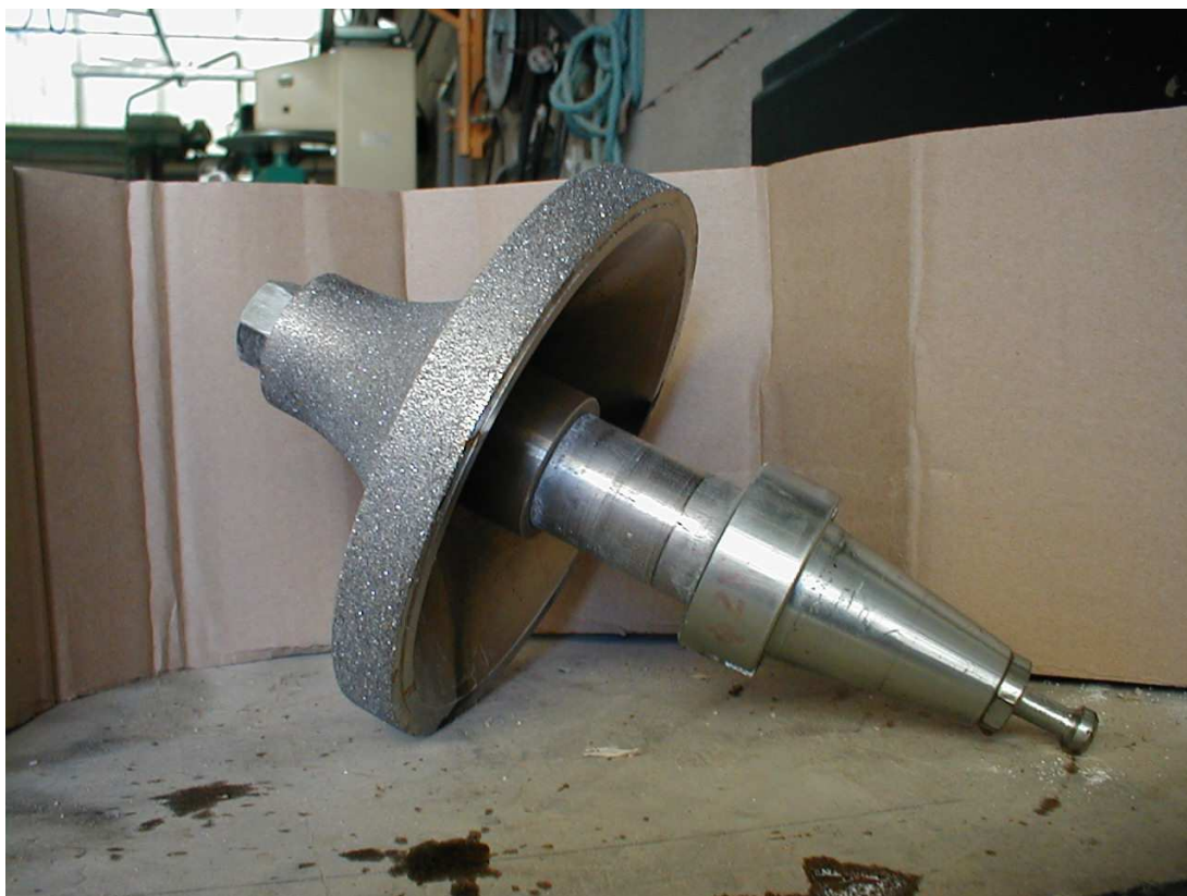
Meules profilées sur mesure pour combiné de façonnage
