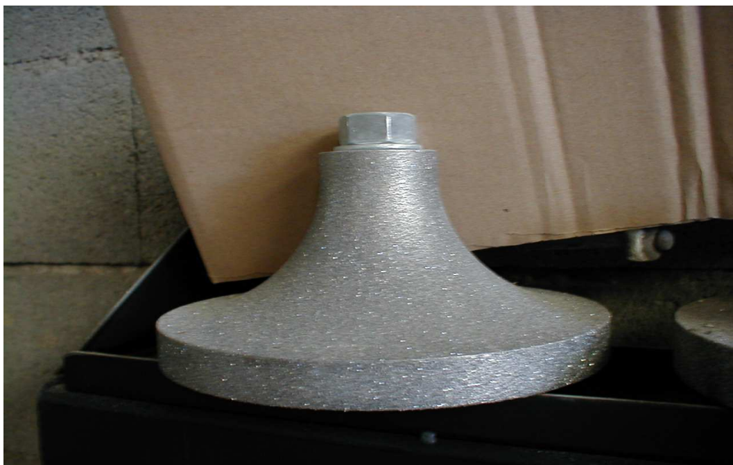
Meules profilées sur mesure pour combiné de façonnage
