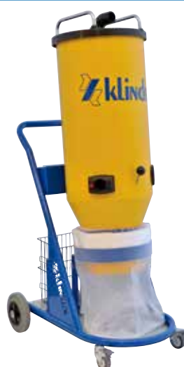
PRÉ-SÉPARATEUR CYCLON 76 Pré-séparateur conçu pour aspirer de grandes quantités de poussière pendant les opérations de ponçage, de carottage, de scarifiage, de coupe, etc. Ces pré-séparateurs particuliers sont équipés des éléments suivants : • « Système cyclon » spécial qui permet de retenir et de ramasser environ 95 % de la poussière aspirée. • LONGOPAC® system qui ramasse la poussière directement dans des sacs en plastique. • Chariot solide avec de grandes roues pour se déplacer facilement aussi sur les chantiers.
