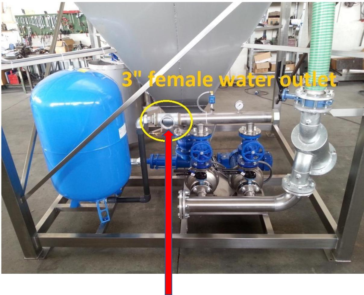
Branchement de l'eau propre à votre circuit à la charge du client par un plombier( qui est à vissé Femelle 3")
