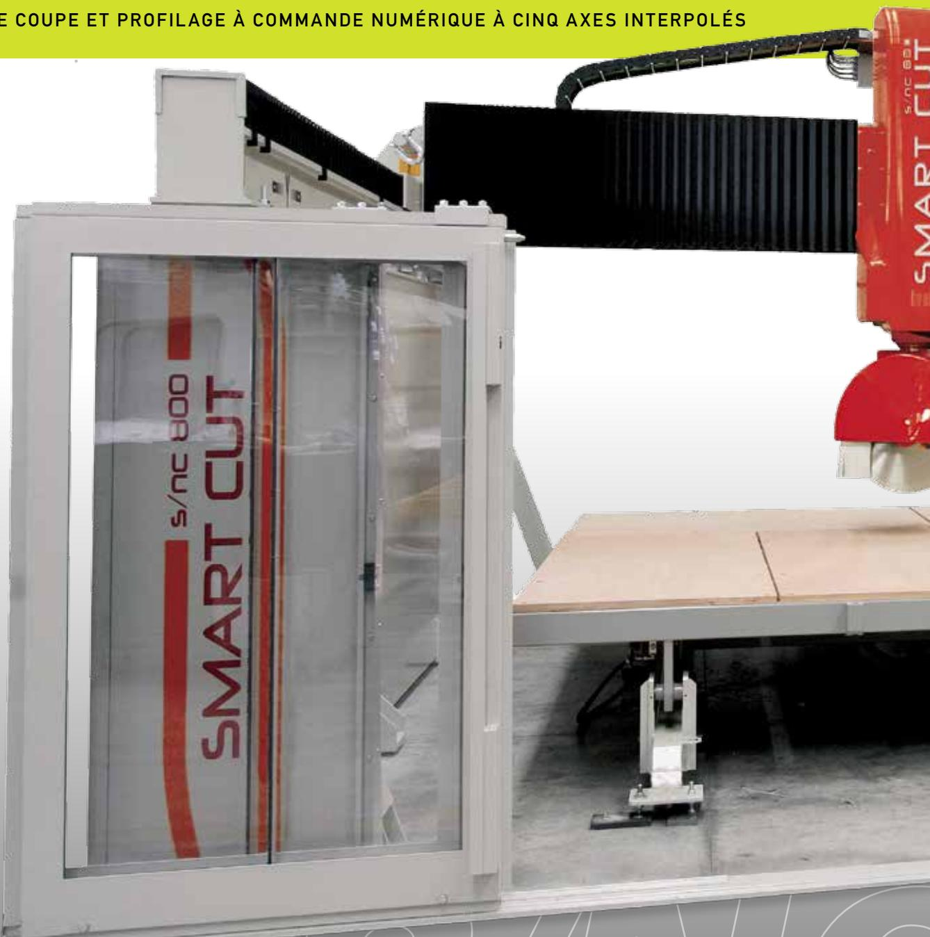
**SMART-CUT S/NC 800** è un centro di taglio e sagomatura a controllo numerico a cinque assi interpolati dotata di testa girevole e banco fisso con pianale basculante (a richiesta).
