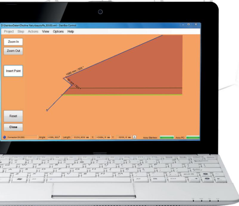
Au cas où vous voulez remanier un mesurage initial, il vous suffit de revoir l'objet mesuré en utilisant le *logiciel de Stairbox*.
