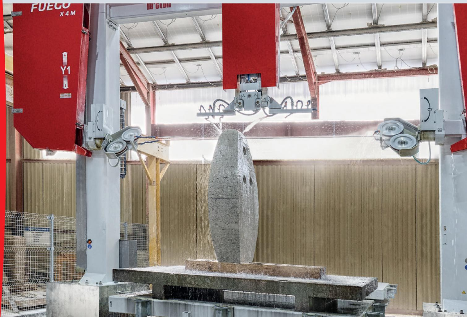
**L'innovante contourneuse à fil diamanté à 4 axes**
