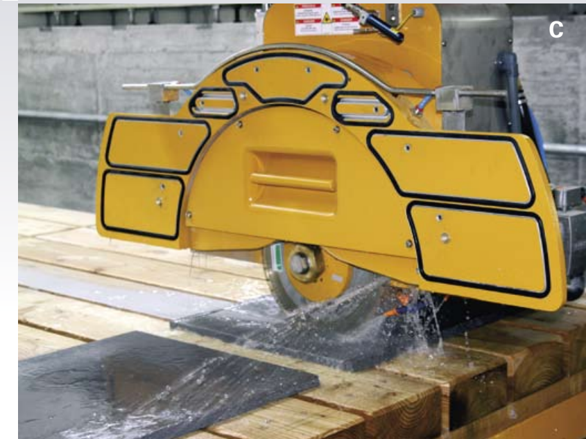
C Nochmals SÄGEN encore une COUPE D SÄGEN DER ARMIERUNGSNUTEN ENTAILLE de RENFORCEMENT
