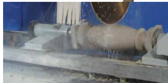
Lathe for the manufacturing of columns, balustrades, pedestals and round-shaped items in general. Tomio per la produzione di colonne, balaustre, piedistalli e manufatti circolari in genere.
